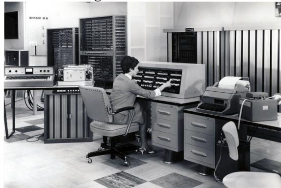
*Das auf der Ausstellung gezeigte Gerät ist ein fast naturgetreuer Nachbau dieser ältesten programmgesteuerten Rechanlage der Welt der ZUSE Z 3.*
