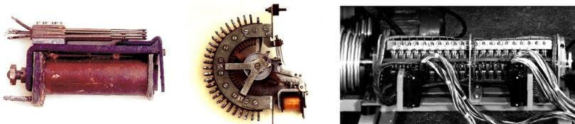
Links ein Relais von 1941, Mitte ein Schrittschalter, rechts der Taktgeber für eine Taktfrequenz von fünf Hertz. Ein moderner PC hat eine Taktfrequenz von 3.000.000.000 Hertz (drei Milliarden, drei Gigahertz).
