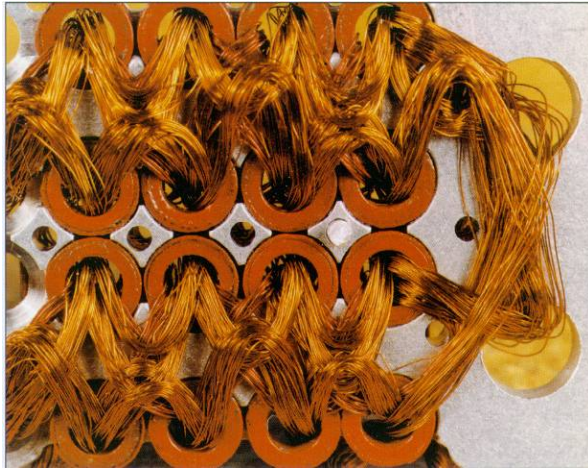
Abbildung 21. Detail eines Core Rope Memory [62]
