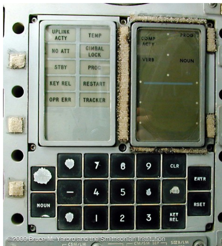
Abbildung 24. Die DSKY-Einheit aus Odyssey, Apollo 13
